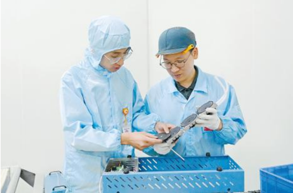
张先杰与同事进行硼扩隔膜泵拆解及大膜片检查
